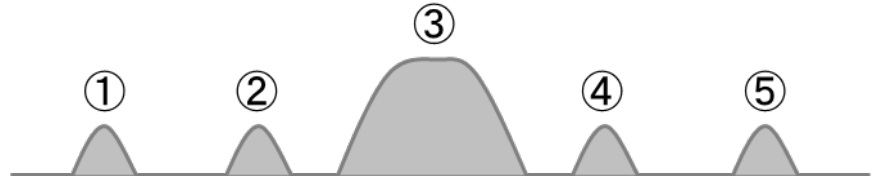
【 電子制御式におけるインジェクターの噴射タイミングと噴射量 】
